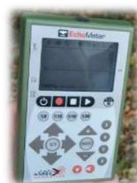
*Figure 17 : Détecteur-Enregistreur d'ultrasons Echometer 3 (EM3)*
