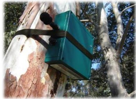
Figure 19 : Enregistreurs autonomes SM2 Bat+
